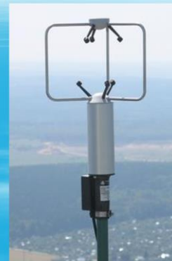
Приборы на высотной мачте: акустические анемометры и датчик температуры воздуха
