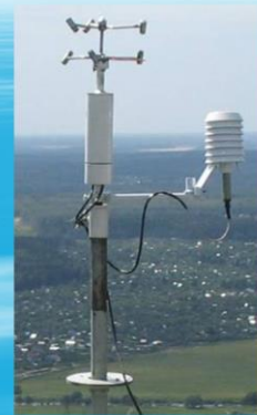
Приборы на высотной мачте: акустические анемометры и датчик температуры воздуха
