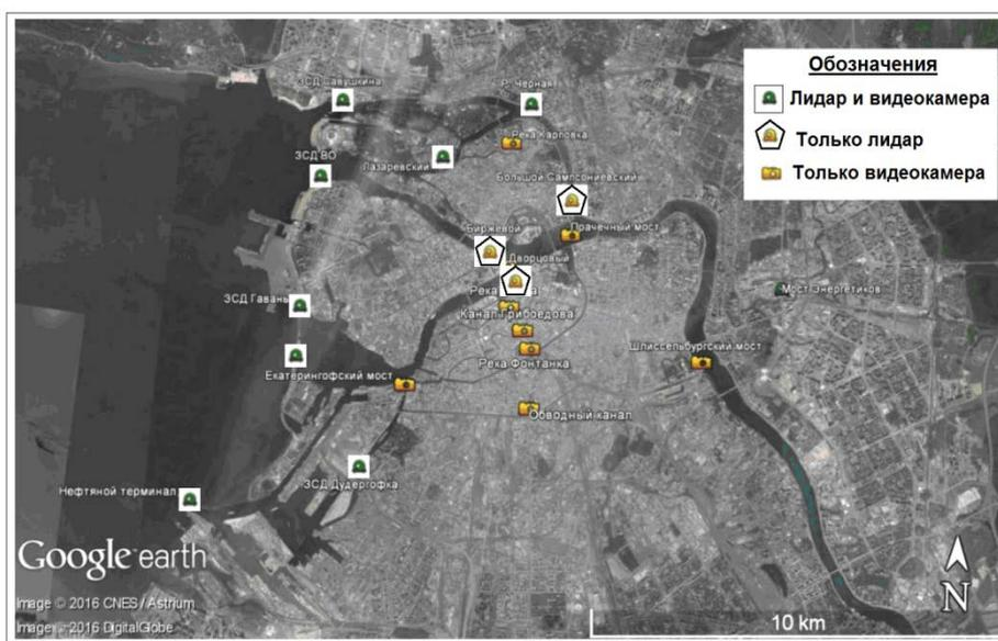
Рис. 1 – Схема предлагаемых элементов дополнения системы мониторинга разливов нефти и нефтепродуктов на акваториях Санкт-Петербурга
