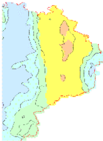
Карта загрязнения ^{137}\text{Cs} , построенная по исходным данным, с населенными на нее исправленными изолянтами.
