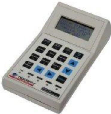
**Рис. 13.** Контроллер «Tekran 1120».
