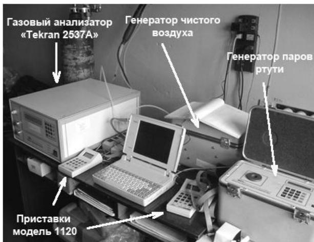
**Рис. 1.** Комплекс оборудования для автоматического измерения содержания ртути в воздухе, установленный на полярной станции «Амдерма» (Россия); Газовый анализатор «Tekran 2537A» используется для измерения (с ультразвуковым пределом обнаружения) концентрации газообразной ртути в приземном слое атмосферы.
