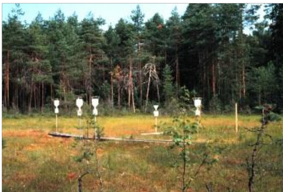
7.3.1 Пример подходящих коллекторов для осуществления выборок осадков.
