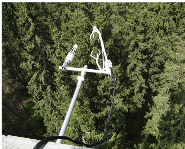
**Рисунок 1.** Акустический анемометр CSAT-3 и инфракрасный CO<sub>2</sub>-H<sub>2</sub>O анализатор LI-7500 на высотной мачте над пологом южно-таежного ельника
