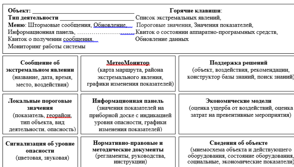
Рисунок 1. Архитектура прикладного программного обеспечения системы ГМО
