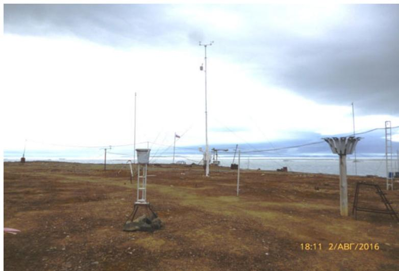
Рисунок 3. Установка для отбора проб атмосферных осадков
