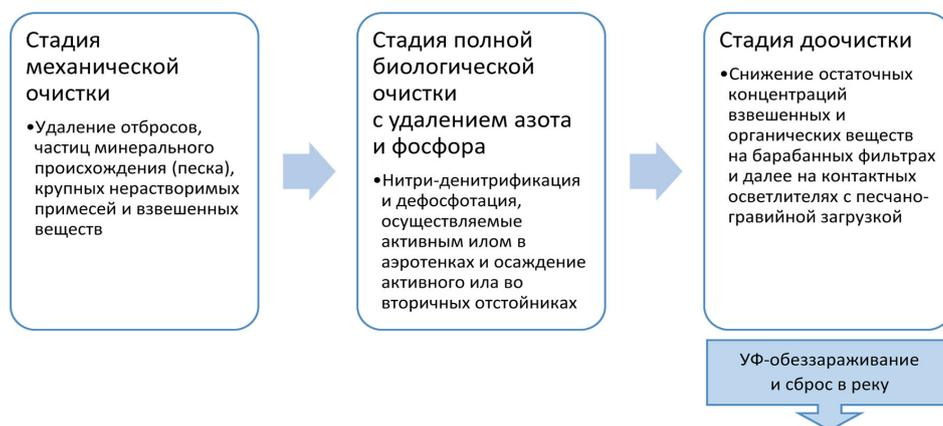
Рисунок 4. Блок-схема реконструируемых очистных сооружений
