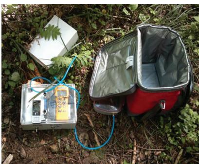
**Рисунок 2.8.** Измерения почвенной эмиссии  $\text{CO}_2$  с помощью анализатора закрытого типа на основе сенсора AZ 7752
