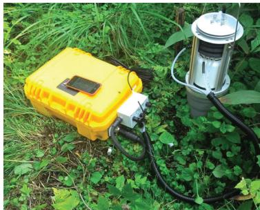
**Рисунок 2.7.** Измерение почвенной эмиссии  $\text{CO}_2$  с помощью газоанализатора LI-8100A и автоматической почвенной камеры (используются стандартные ПВХ-основания).
