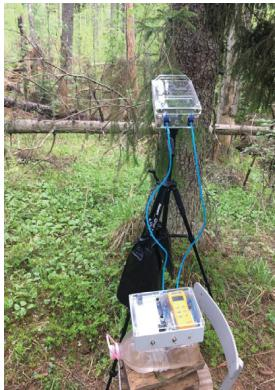
**Рисунок 2.43.** Измерение темновой (А) и световой (Б) фаз газообмена ели в старовозрастном ельнике (на фото аспирант А. Куманяев)
