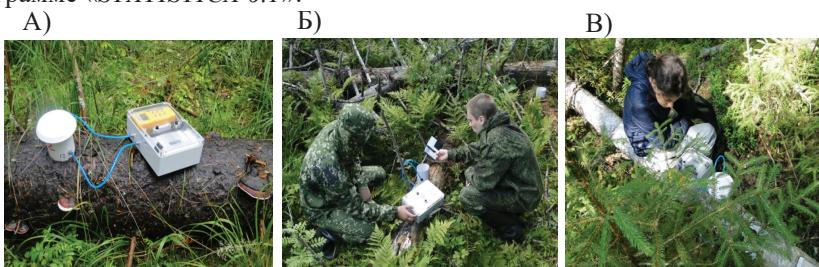
**Рисунок 2.41.** Измерение потока CO<sub>2</sub> от древесных остатков в ельнике мелкотравно-зеленомошном (А), в окне распада елового древостоя (Б) и в заболоченном березняке (В).
