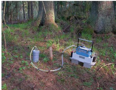
**Рисунок 2.6.** Измерение почвенной эмиссии  $\text{CO}_2$  в 110-летнем ельнике мелкотравно-зеленомошном с помощью газоанализатора LI-6200
