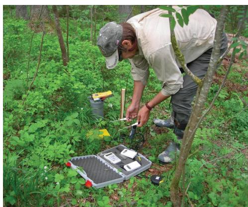
**Рисунок 2.22.** Измерения эмиссии CO<sub>2</sub>, температуры и влажности почвы на одном из постоянных ПВХ-оснований трансекты с помощью модифицированного прибора на основе газоанализатора AZ 7752 (май 2013 г.)
