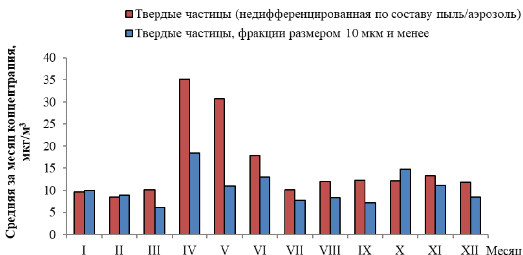
Рис. 4.2. Внутригодовое распределение концентраций твердых частиц в атмосферном воздухе Березинского заповедника, 2019 г.
