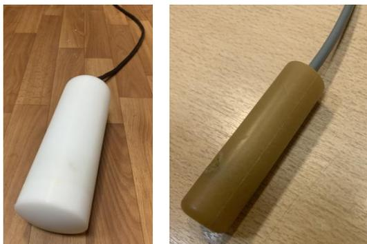
**подводная часть (логгер и передатчик)**      **погружная часть (приёмник)**
