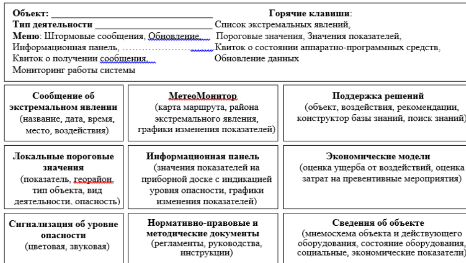
Рисунок 1. Архитектура прикладного программного обеспечения системы ГМО
